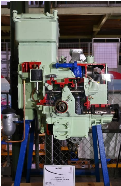
Aufgeschnittener 2ZG9 Baujahr ca. 1950, für Lastwagen, Schiffe
