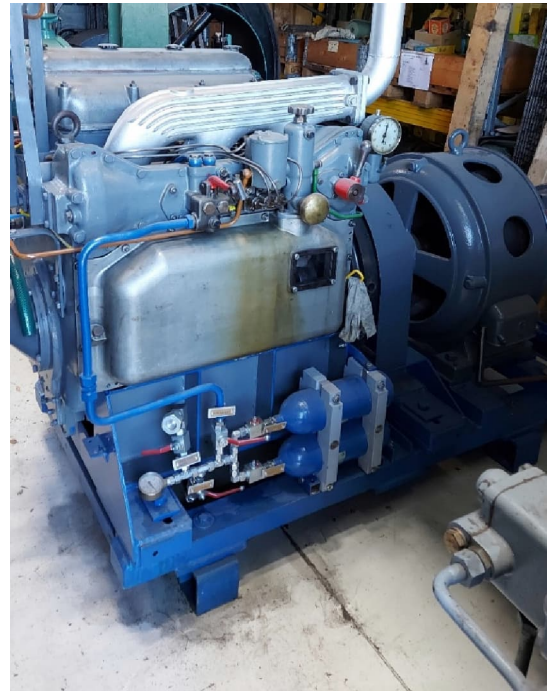
Der 3ZG9 wurde mit Luftflaschen ausgerüstet damit wir nicht immer unser grosses Startermodul an Ausstellungen mitnehmen müssen
